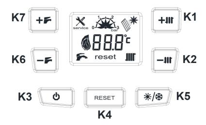
**K1** CH setpoint adjustment (+) **K5** DHW / CH+DHW modes enabling
