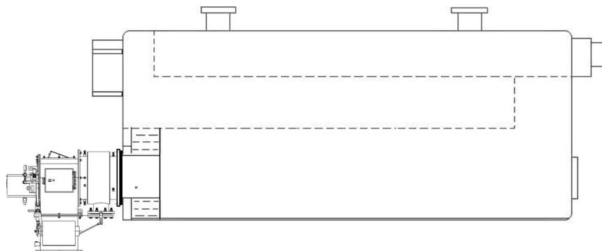
Silindirik kazanlarda brülörü monte ederken, alev borusunun uç kısmının kapak izolasyon malzemesi ile aynı düzlemede olmasına dikkat edilmelidir.
